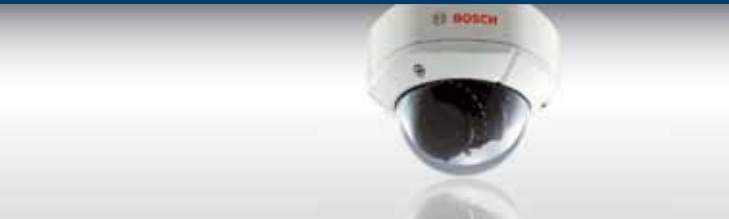
VDN-240V03-2 Venkovní kamera Den/Noc s kopulovým krytem Objektiv s ohniskovou vzdáleností 2,8–10,5 mm, 540 TV řádků, NTSC, 12 V DC, 24 V AC
